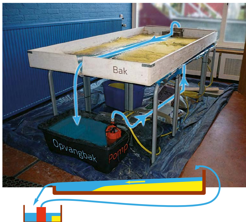
Fig. 2b: Foto van stroomgootopstelling (vooraanzicht). Kleuren van de pijlen corresponderen met kleuren in Fig. 2b: bak (foto wit/schema bruin) met zand (geel), water (blauw), waterkringloop (blauwe pijlen) via de pomp (rood) en de opvangbak (zwart/bruin, rechtsonder)
